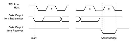
FIGURE 13. ACKNOWLEDGE RESPONSE FROM RECEIVER
