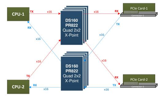
Figure 8-1. 2x2 Cross point for x16 bus width using DS160PR822
