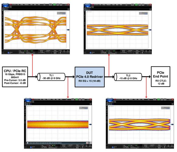
Figure 8-4. PCIe 4.0 Link Reach Extension Using DS160PR822
