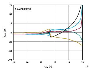
Figure 14. V<sub>OS</sub> vs. V<sub>CM</sub>, High V<sub>CM</sub> Operation
