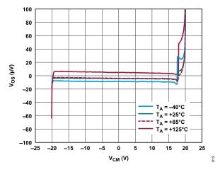
Figure 13. V<sub>OS</sub> vs. V<sub>CM</sub>, Four Temperatures
