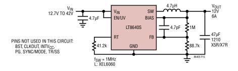
Figure 15. 12V, 6A Step-Down Converter
